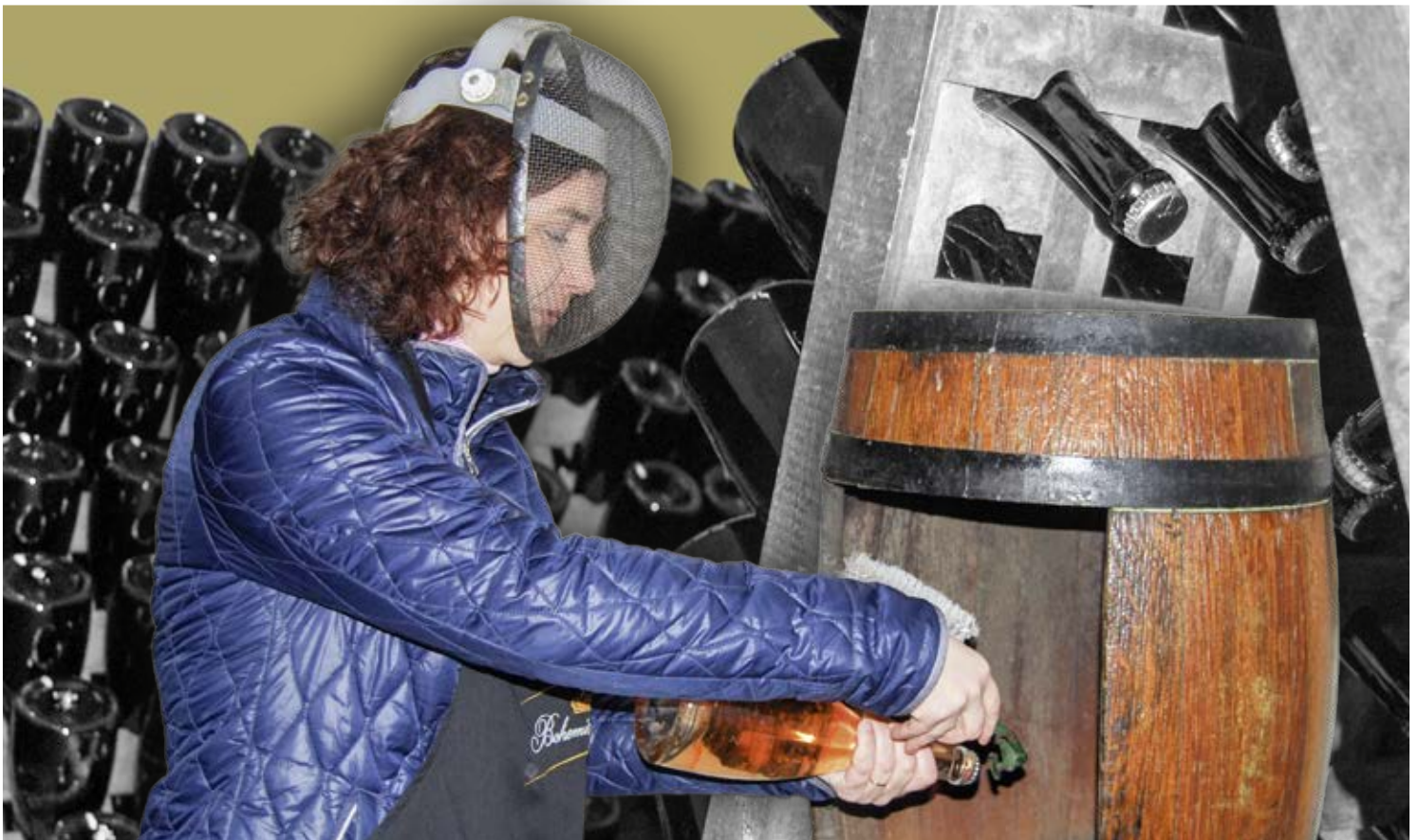
Schutzkleidung ist nötig, wenn der Kronkorken vom Flaschenhals gerissen wird. „Degorsage“ heißt dieser Arbeitsschritt, den Lucie Kučerova demonstriert. (Foto: Franck)
